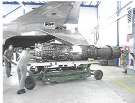
Mit größter Vorsicht werden die Triebwerke aus den auszuphasenden Luftfahrzeugen entfernt.
